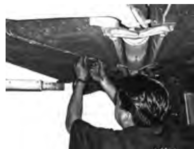
Revisión de la tubería de frenos
