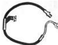
Manguera para frenos con curvatura en el tubo de banjo
