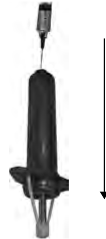
Llenado del cilindro de clutch en posición vertical
