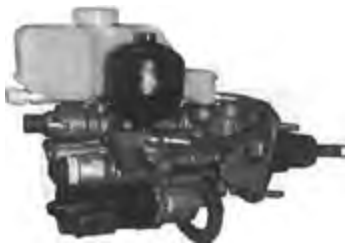
Sistema abierto hidroreforzado
