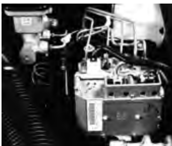
Frenos ABS tipo no integral o abierto
