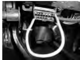
Punteando las terminales del conector DLC
