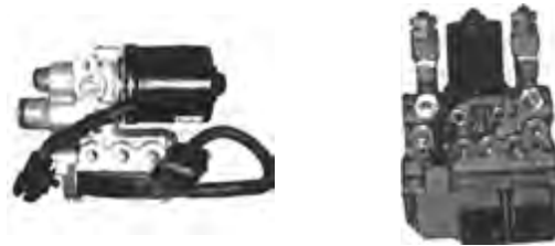
Sistemas cerrados no hidroreforzados
