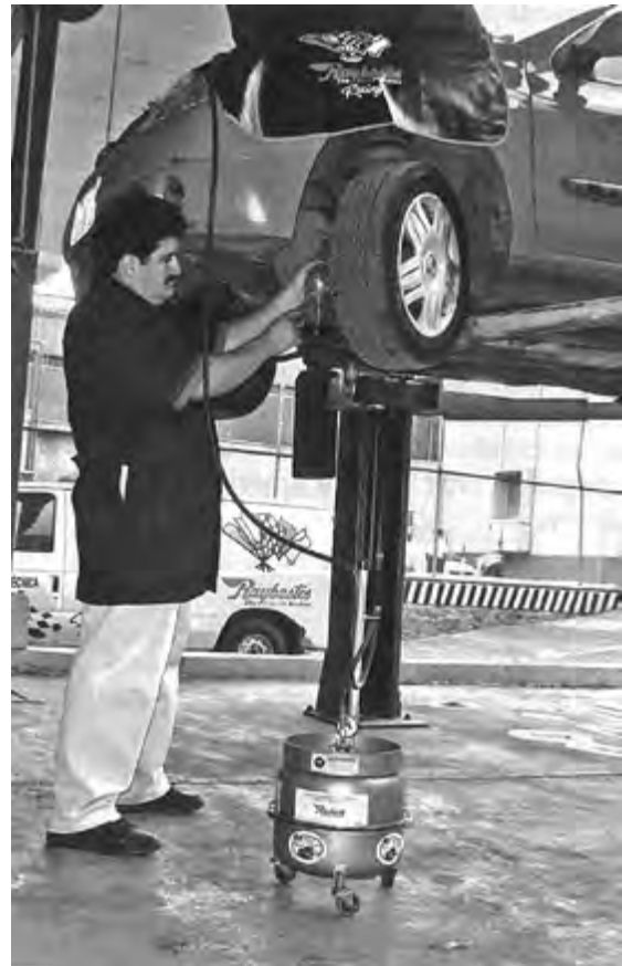
Purgado con tanque de purga a presión
