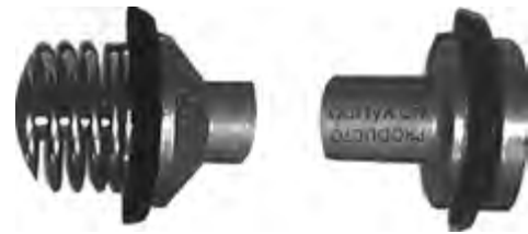
Gomas primaria y secundaria hinchadas
