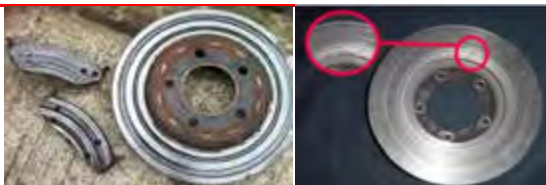
Disco con surco provocado por la balata
