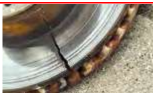
Disco roto fuera de especificación
